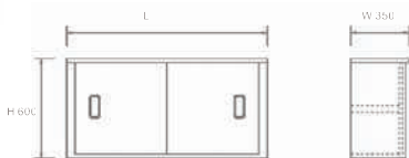
Model Dimension L×W×H(mm) BV-45 1200×350×600 BV-46 1500×350×600 BV-47 1800×350×600
